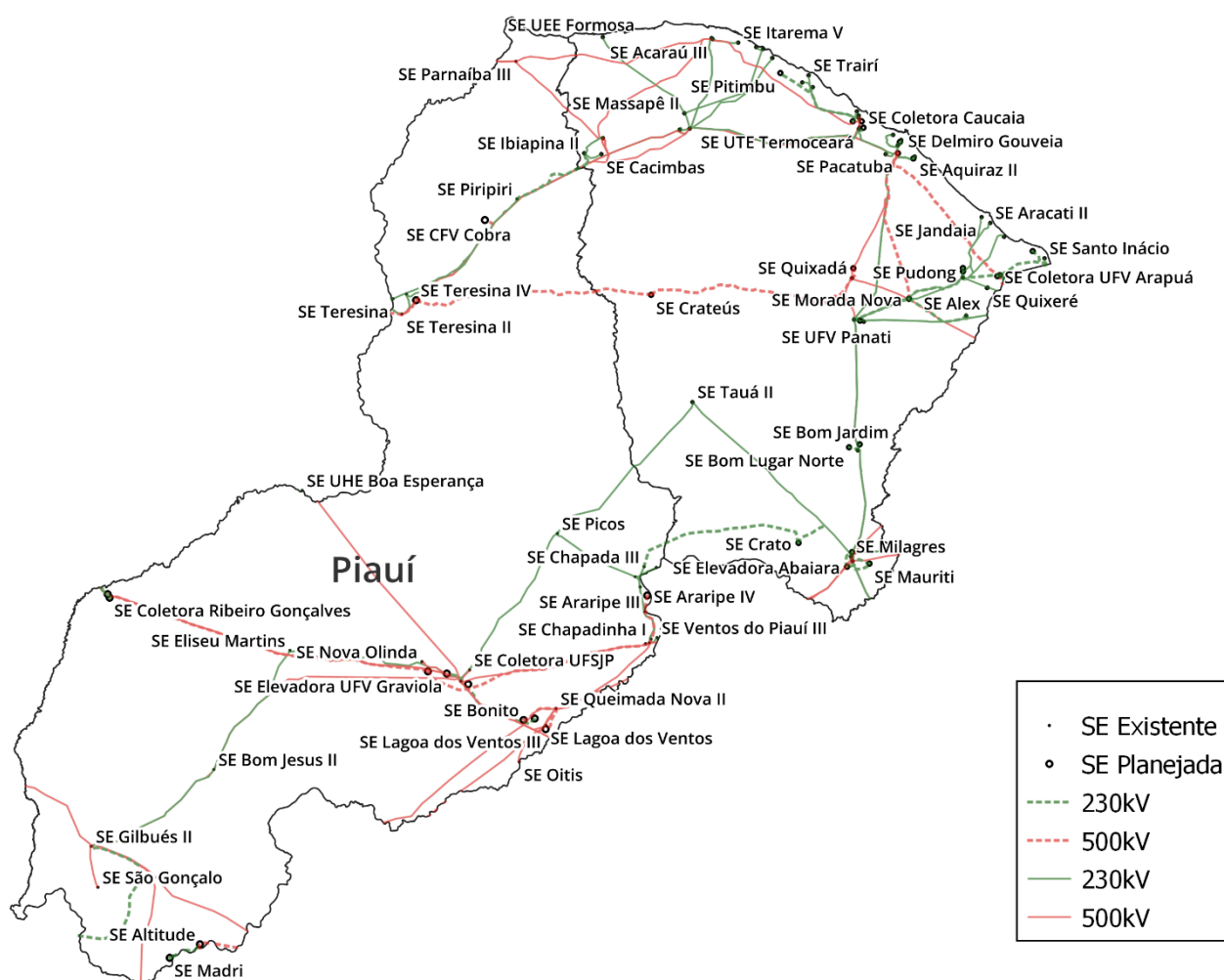
Figura 4-1 – Sistema Elétrico da Região Nordeste – Área Norte
