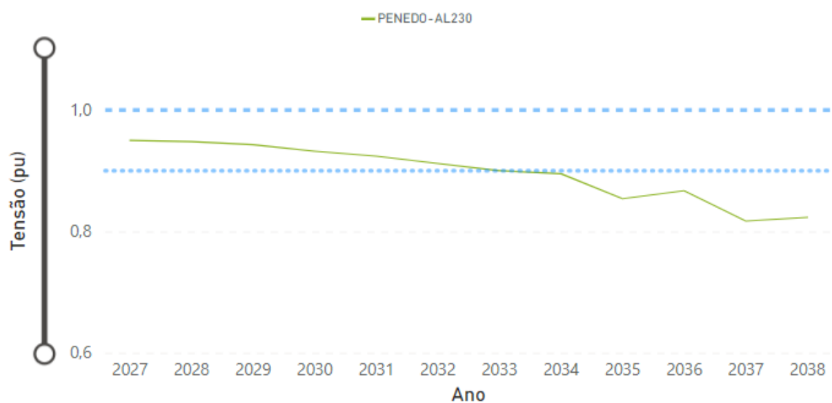
Figura 6-4 – Carga Pesada – Barra 230 kV Penedo
