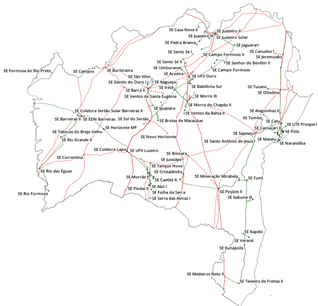
Figura 4-15 – Sistema de Transmissão do Estado da Bahia
